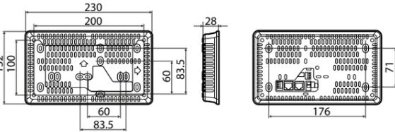
Принадлежности для скрытого настенного монтажа (см. рис.1d) - Арт.: PGTA00RM70
