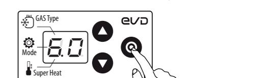
7 Appuyer sur PRG/Set pendant 2 s pour quitter la procédure de première mise en service et activer la régulation. L'écran repasse à l'affichage standard (mesure de la surchauffe).
