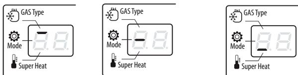
A. Refrigerante B. Modo di funzionamento C. Set point di surriscaldamento
