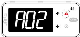
Premendo il pulsante "Alarm" per 3s è possibile resettare il singolo allarme
