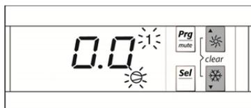
La pressione simultanea di e , in fase di visualizzazione del valore del contaore (per es. parametro c10), porta all'azzeramento del contaore stesso e conseguentemente alla eventuale cancellazione della richiesta di manutenzione.
