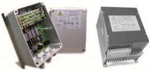
Le apparecchiature della serie FCS sono dei regolatori elettronici di tensione trifase che utilizzano il principio del taglio di fase per regolare la tensione in uscita fornita al carico, in funzione del segnale di comando applicato all'ingresso. Sono in grado di pilotare motori elettrici asincroni collegati, ad esempio, a ventilatori assiali, pompe, miscelatori, agitatori ecc.
