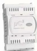
La scheda, collegata in rete tLAN al controllo, possiede 5 ingressi digitali e 5 uscite digitali. La commutazione di ogni ingresso digitale può essere associata ad una determinata segnalazione di allarme visualizzata sul display del controllo e a una commutazione sull'uscita digitale scelta.
