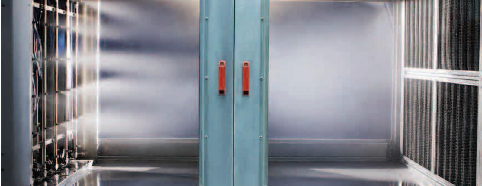
Test en gaine auprès du laboratoire CAREL: jusqu'à 95% de l'eau atomisée est absorbée par l'air qui est ainsi efficacement humidifié et rafraîchi, en minimisant les consommations d'eau et d'énergie.
