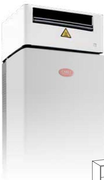
Le **testate ventilanti** possono essere **installate direttamente sull'umidificatore o remote**. Nel secondo caso viene fornito un supporto e un tubo vapore per collegare la testata all'umidificatore. La testata ventilante funziona in modalità ON/OFF and è controllata da un dispositivo termico che l'attiva quando viene prodotto vapore.
